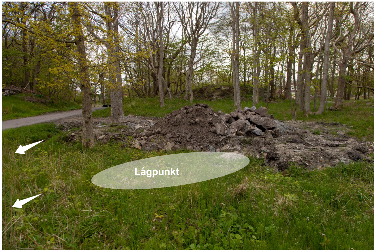
Figur 12 Lågpunkt i nordvästra hörnet som delvis fyllets igen. Pilar visar flödesriktning.
